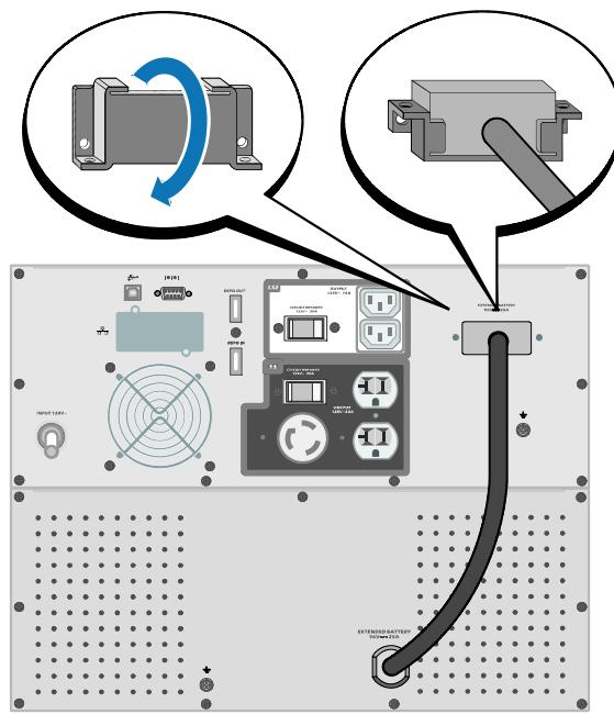
**2** Установите крышку разъема батарей под кабель МВБ, чтобы снизить натяжение.
