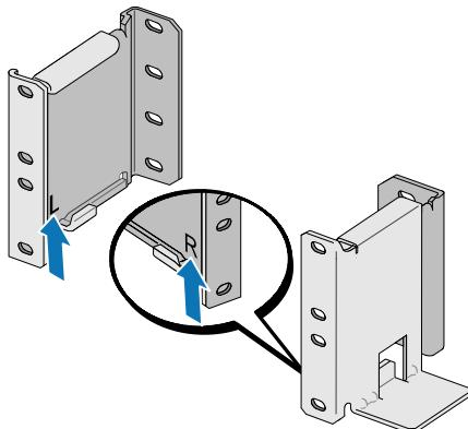
**■ 注意：**方孔機架和無螺紋的圓孔機架的操作說明相同。導軌適用於這兩種機架。
