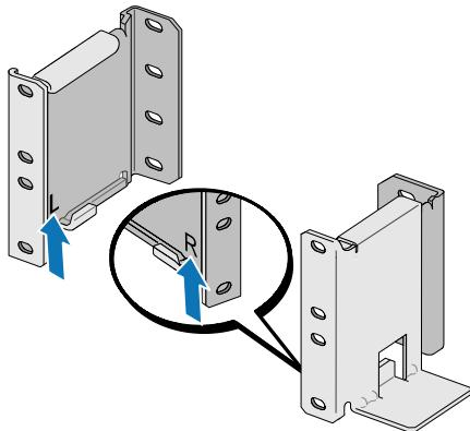
**참고:** 사각 구멍 랙과 나사산 없는 원형 구멍 랙에 대해 설치 지침은 동일합니다. 레일은 두 종류의 랙에 모두 맞습니다. 원형 구멍 랙은 그림에서 볼 수 있습니다.
