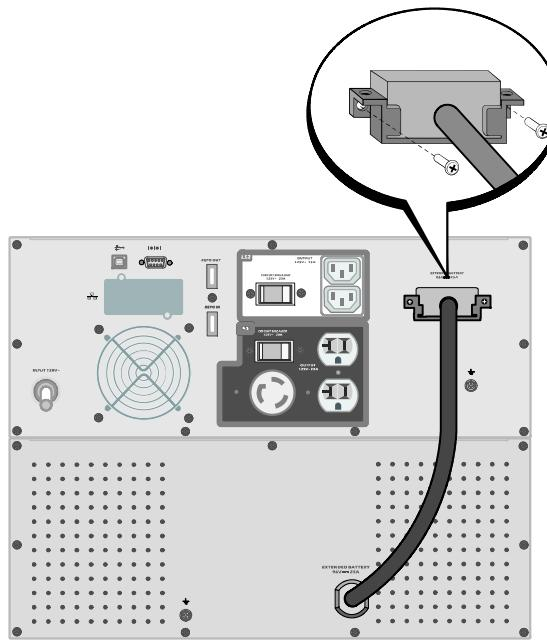
**3** 将EBM电缆插入 UPS 电池连接器。
